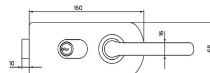
**CERRADURA CENTRAL CON BOMBILLO EXTERIOR, MODELO CON DOBLE MANILLA Y CONDENA INTERIOR PARA MARCOS CON GALCE Y RESBALÓN DESPLAZADO**
